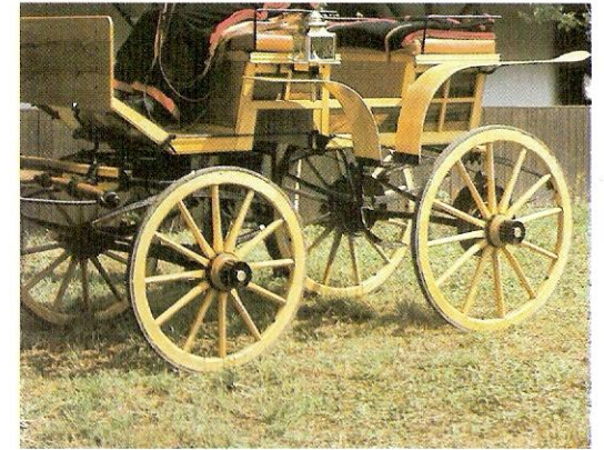
21. Károlyi- vagy más néven fóti kocsi, a hátsó kerekein hidraulikus lábfékkel. (A Mezőhegyesi Mezőgazdasági Kombinát tulajdona)
